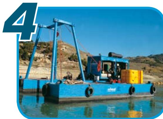
**Movimentazione e posizionamento scafo tramite verricelli.**
